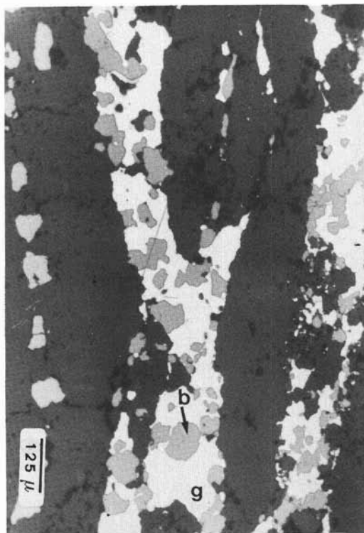
Fig. 6. — Contrada Bosci (Fraz. Molino c/o Giampilieri) - Lettini pressoché esclusivamente bifasici a galena ( g ) e blenda ( b ). Quest'ultima non presenta mai inclusi. Nicols paralleli. — Contrada Bosci (Molino c/o Giampilieri) - Mineralized layers with galena ( g ) and sphalerite ( b ); this last always inclusion free. P.P.L.
