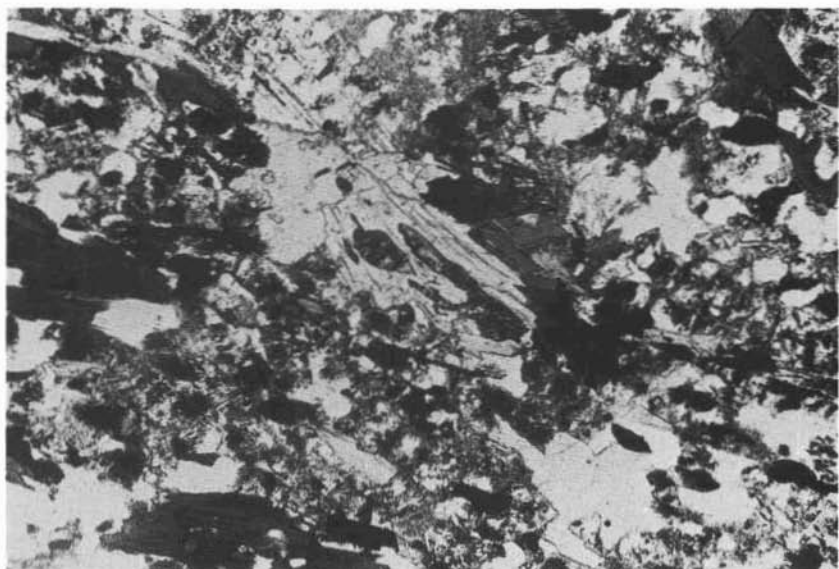
Fig. 3. — Sostituzione della staurolite da parte di mica bianca. I = 90 \times ; N. paralleli.
