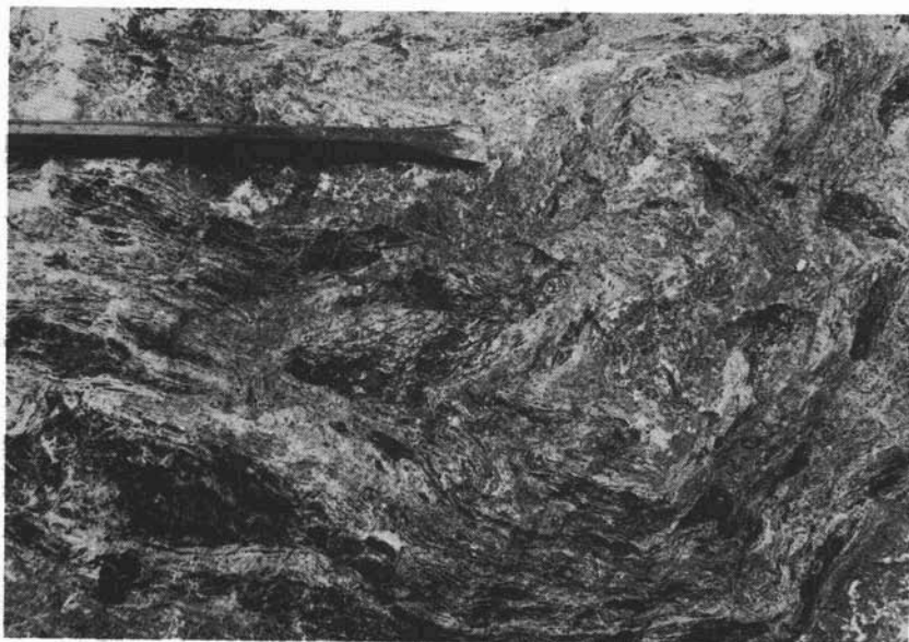
Fig. 1. — Aspetto caratteristico della roccia oficarbonata con elementi prevalentemente antigoritici (scuri) e zone a tenori in carbonati gradualmente più alti (progressivamente più chiare). Sono ben riconoscibili pieghe d_2 (ad asse approssimativamente orizzontale sulla foto) ed un blando ripiegamento d_3 (ad asse pressochè verticale).
