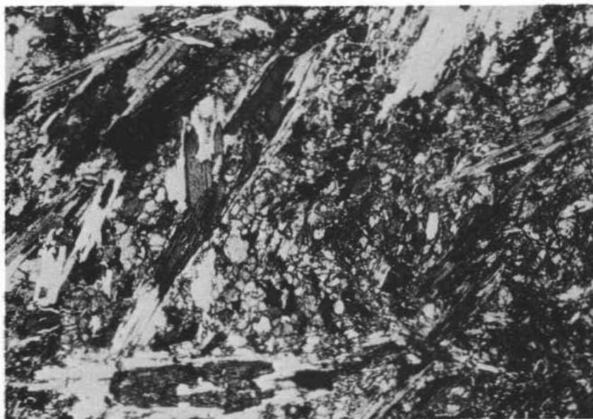
Fig. 5. — Banda serpentinoscistosa nella roccia oficarbonata. Olivina e diopside granoblastici coesistenti con antigorite lamellare a nucleo di pennina (più scuro nella foto) (ingr. lineari 35, nicols incrociati).
