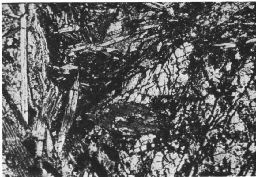
Fig. 7. — Roccia oficarbonata: coesistenza di diopside, tremolite, antigorite e carbonati (ingr. lineari 45, nicols incrociati).
