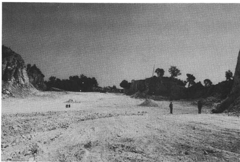
Fig. 2. — Attuale zona di estrazione di M. Sughereto. La coltivazione viene effettuata preferibilmente secondo gradoni, mettendo in evidenza talvolta gli andamenti di vecchie gallerie.
