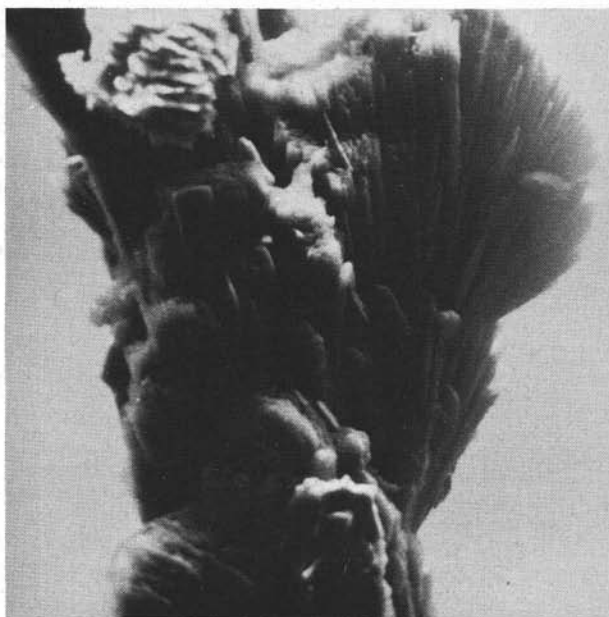
Fig. 21. — Particolare della parte terminale degli aggregati coralloidi che risulta costituita da individui fibrosi. Ingrand. lineare 1000 X.
