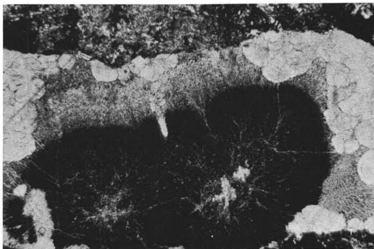
Fig. 9. — Thomsonite di diverse generazioni: la prima costituisce sferule ben sviluppate e limpide sulle pareti della frattura; la seconda, che forma aggregati di cristalli aciculari finemente concresciuti con gel di silice, è ricca di impurezze diverse che le conferiscono aspetto semiopaco. Solo polarizzatore. Ingrand. lineare 25 X.
