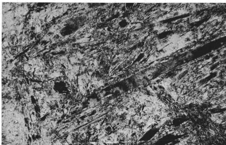
Fig. 6. — Natrolite completamente sostituita da thomsonite e opale. Solo polarizzatore. Ingrand. lineare 40 X.
