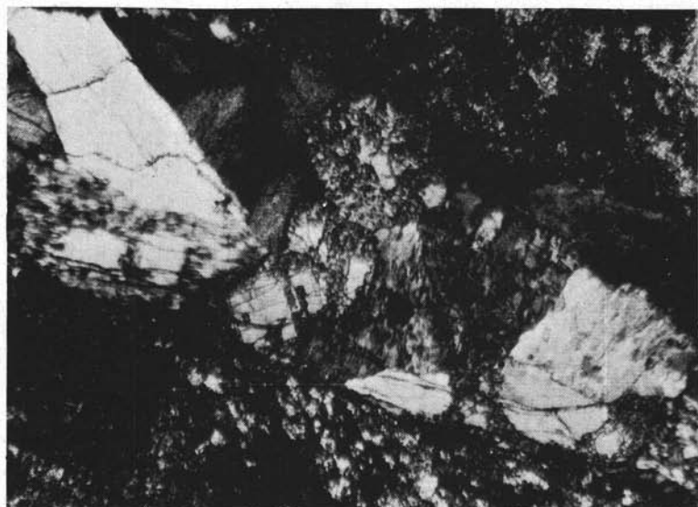
Fig. 11. — Natrolite in associazione con mesolite. Le sezioni basali al centro della foto mostrano la caratteristica geminazione polisintetica di questi cristalli. Nicols incrociati. Ingrand. lineare 40 X.
