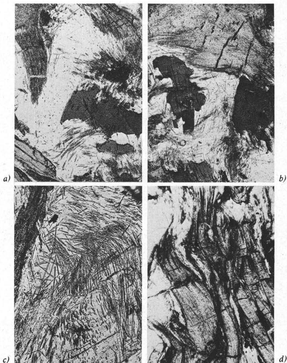
Fig. 12. — a ) Sillimanite sincinemática e biotite postcinemática. (Solo polarizzatore; ingr. lin. 45). - b ) Come la precedente. (Solo polarizzatore; ingr. lin. 45). - c ) Sillimanite fibrolitica. (Solo polarizzatore; ingr. lin. 100). - d ) Sillimanite a covoni parzialmente trasformata in un finissimo aggregato sericitico. (Solo polarizzatore; ingr. lin. 35).
