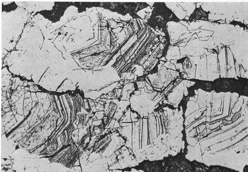
Fig. 1. — Relitti di una pirite zonata e in parte colloforme, presumibilmente premetamorfica, inclusi nella pirite relativamente omogenea di natura cristalloblastica. Calcopirite e blenda subordinate. Giacimento di Degtiarka, Urali. (attacco elettrolitico; luce riflessa; ingr. lin. 230)
