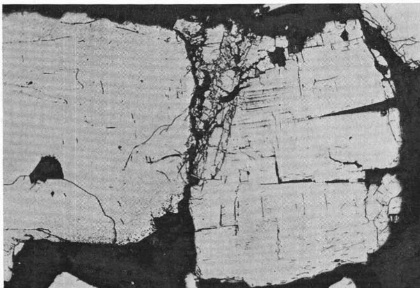
Fig. 2. — Urto fra due cubi di pirite cristalloblastica in ganga prevalentemente quarzosa. Giacimento di Sain Bel, Rodano. La deformazione plastica, che è denunciata da lamelle di scorrimento ed altri indizi, risulta seguita da una locale intensa cataclasi. (attacco elettrolitico; luce riflessa; ingr. lin. 225)
