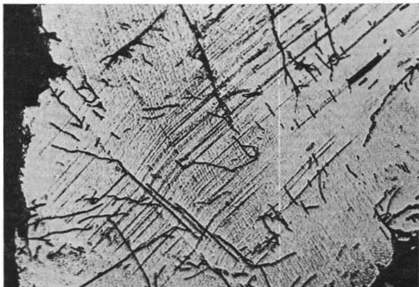
Fig. 9. — Sistema di lamelle di scorrimento nella pirite cristalloblastica del giacimento di Kalwang, Stiria. E' accennata una struttura a blocchi individuati da discontinuità nell'orientazione delle lamelle (« kink banding »). E' inoltre riconoscibile un secondo debole sistema lamellare ortogonale al primo.
