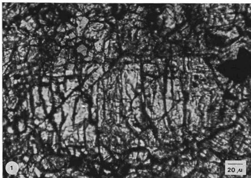
Fig. 1. — Un cristallo idiomorfo di olivina con fratture ad andamento regolare ed irregolare. Luce trasmessa, nicols //
