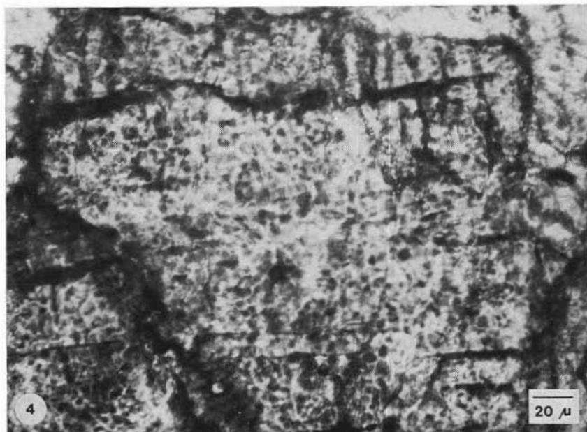
Fig. 4. — Microfratture (« cracks ») in un granulo di olivina.
