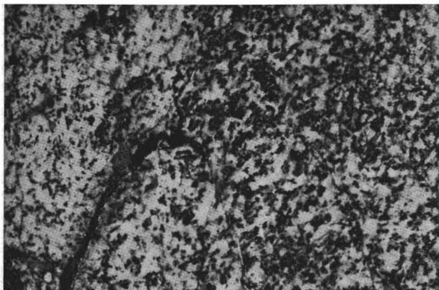
Fig. 2 — Aspetto macroscopico comune della roccia. E' visibile una venuzza di oligisto, bordata da aloni color ruggine, diffusi anche nella parte sinistra della fotografia.
