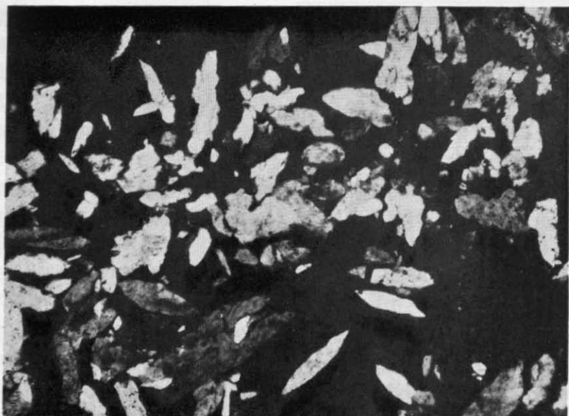
照片 2. 多水氯硼鈣石晶體(+偏光, \times 25 )
