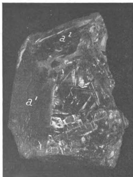
Fig. 5. — Cannelures triangulaires de corrosion sur une face (0001) de béryl riche en alcalis.
