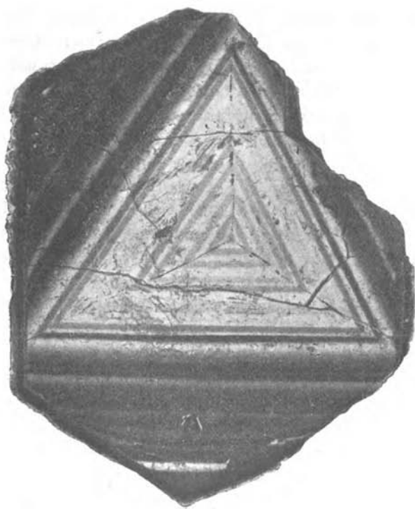
Fig. 3. — Section (0001) d'un cristal d'Anjanabonoana; les parties claires sont roses, les foncées vertes. (Réduction d'une photographie faite par contact direct.)
