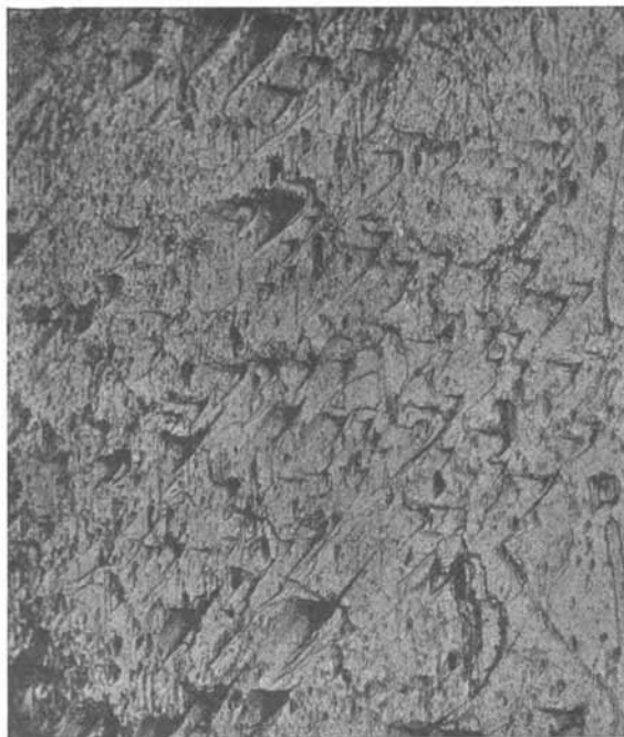
Fig. 6. — Figures de corrosion naturelle d'une face m (110) de triphane; le côté gauche du cliché correspond à l'arête (110 : 100).
