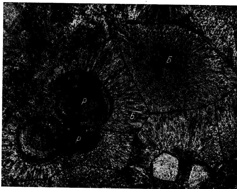
Рис. 2. Роуито (Р)-ботриолитовые (Б) сферолиты в свабитсодержащем гранато-везувиановом скарне. Ник. скрещ., увел. 72.
