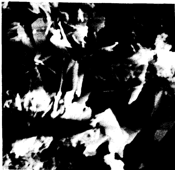
FIG. 1. — Cristaux tabulaires de comblainite de Shinkolobwe. Photographie au microscope électronique à balayage \times 4\,000 .
